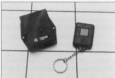
De zender en de ontvanger van het Flare alarmsysteem.
